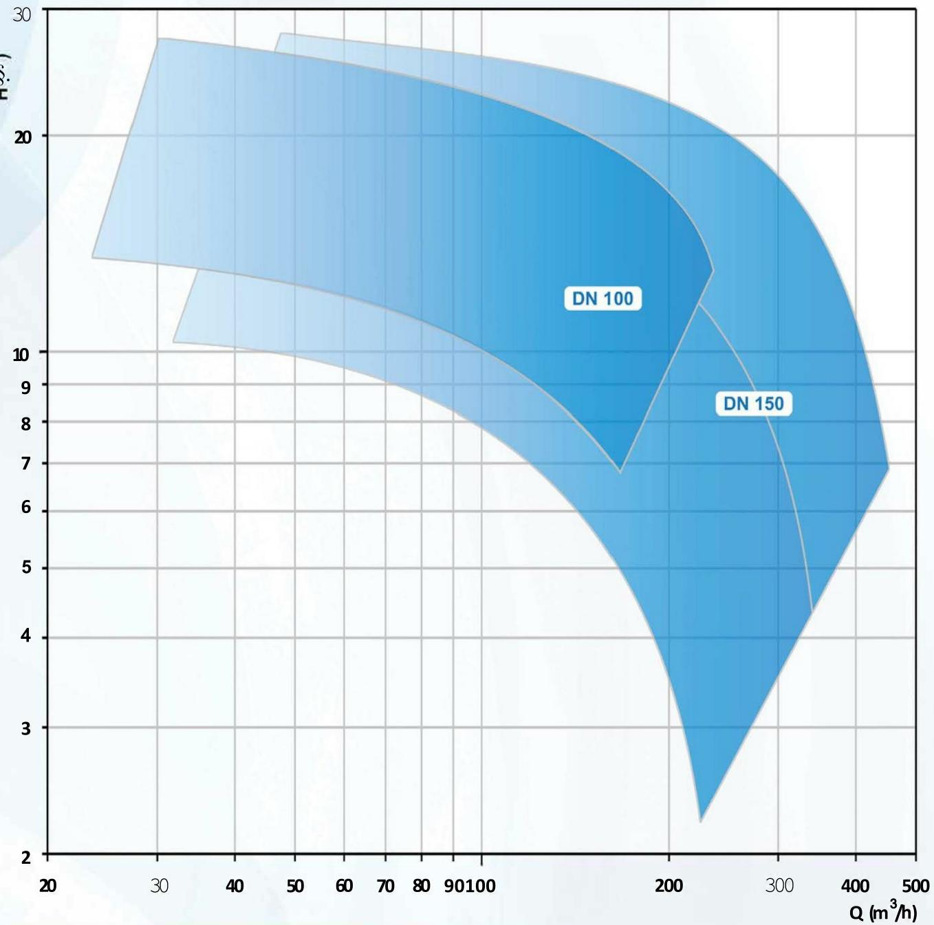
Die Produktpalette umfasst verschiedene Modelle von **7.0 kW** bis **30 kW** RPM **1450**
